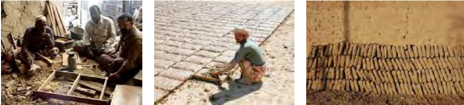
Fig. 3 – A sin. telaio per fare due mattoni di fango; al centro e a destra mattoni di terra-fango (mudbricks).
